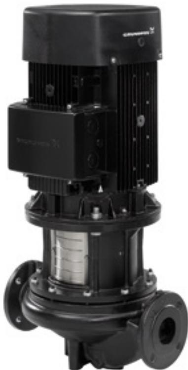
Вертикальные, многорядные насосы Grundfos TP и TPE используются в различных областях применения. Данные насосы являются одноступенчатыми, многорядными, центробежными насосами со стандартными двигателями и торцевыми уплотнениями вала. Данные насосы имеют короткую муфту, т.е. насос и двигатель являются отдельными блоками. Соответственно данные насосы менее чувствительны к загрязнениям перекачиваемой жидкости, чем аналогичные насосы с герметизированным ротором.
