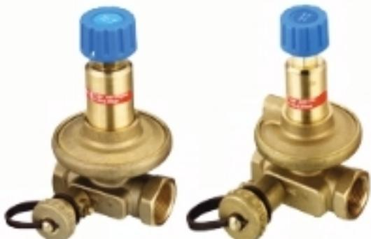
Автоматические балансировочные клапаны серии ASV – регуляторы постоянства перепада давлений, предназначенные для гидравлической балансировки трубопроводных систем тепло- и холодоснабжения при переменных расходах проходящей через них среды в диапазоне от 0 до 100%.
