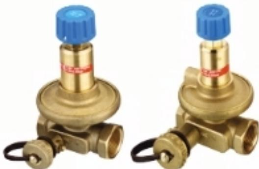
Автоматический комбинированный балансировочный клапан AB-PM - регулятор постоянства перепада давлений, предназначенный для гидравлической балансировки систем отопления при переменных расходах проходящего через него теплоносителя в диапазоне 0-100%.
