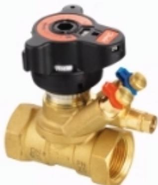
Клапан-партнер ASV-BD применяется совместно с автоматическим балансировочным клапаном ASV-PV/P для контроля и поддержания постоянного перепада давлений в обслуживаемых стояках или ветках систем отопления, тепло- и холодоснабжения. ASV-BD сочетает в себе функции ручного балансировочного клапана и шарового крана, а также обладает рядом особенностей:
