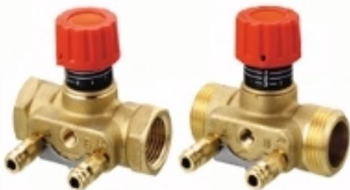
С помощью запорно-балансировочного клапана ASV-I можно перекрыть поток перемещаемой по трубопроводу среды, произвести ограничение максимального расхода теплоносителя, проходящего через регулируемый участок системы, путем изменения пропускной способности клапана за счет ограничения степени его открытия (величины подъема штока), измерить количество теплоносителя, протекающего через данный участок системы, и присоединить импульсную трубку от регуляторов ASV-P, ASV-PV или ASV-PV Plus.
