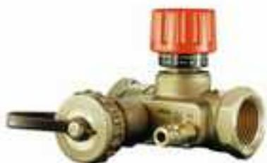
USV-I сочетает в себе функции клапана переменного гидравлического сопротивления, перенастраиваемого вручную, и запорного клапана. USV-I ограничивает максимальный расход тепло или холодоносителя через стояк или установку. Клапан снабжен измерительным ниппелем и дренажным краном.
