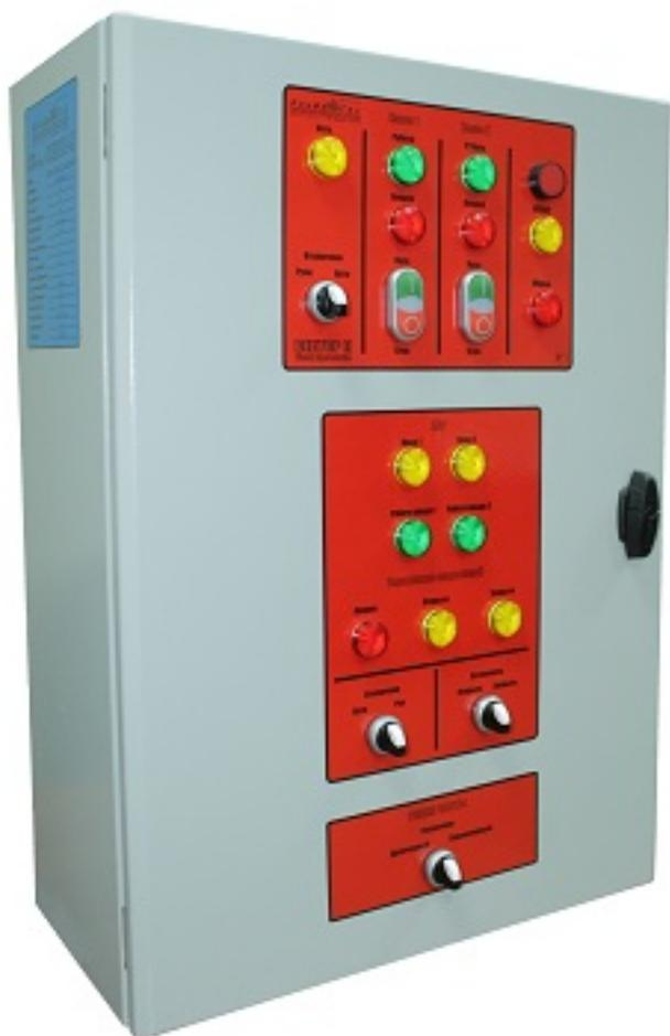
Шкафы управления серии «ВЕКТОР-П» **предназначены** для использования в системах спринклерных и дренчерных системах пожаротушения и обеспечивают формирование сигналов управления насосами и электроприводами задвижек в ручном и авто режимах. Шкафы ВЕКТОР-П могут быть выполнены практически под любое тех задание заказчика и на любую мощность подключаемых насосов.
